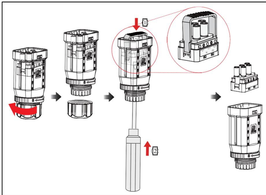
Prima di connettere il terminale di Rete/Backup, assicurarsi che gli interruttori di CA e CC siano aperti e che lo sia anche il sezionatore della connessione FV. Altrimenti sussiste il pericolo di shock elettrico. Connessione Rete/Backup far riferimento di seguito.
