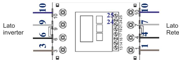
Prima di connettere l'inverter alla rete, si prega di installare un sezionatore CA esterno ( $\geq 40A$ , non compreso) tra l'energy meter e la Rete. Questo permette di scollegare l'inverter in sicurezza durante la manutenzione.
