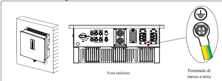
**AVVERTENZA** L'inverter deve essere connesso a messa a terra; altrimenti, può sussistere io pericolo di shock elettrico.
