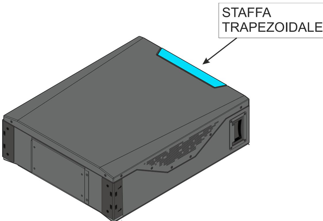
L'installazione della pila si conclude bloccando i moduli utilizzando le staffe del modulo come mostrato di seguito.
