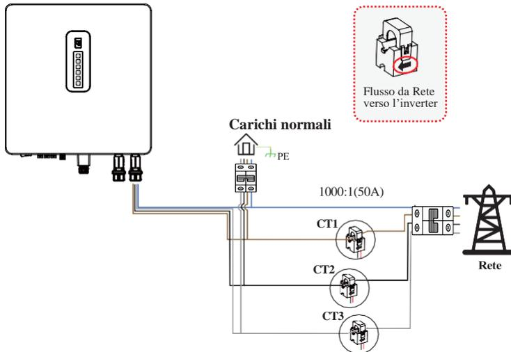
Si prega di fare attenzione al verso di collegamento del CT. La freccia presente sul sensore rappresenta il verso della corrente dalla Rete verso l'inverter.
