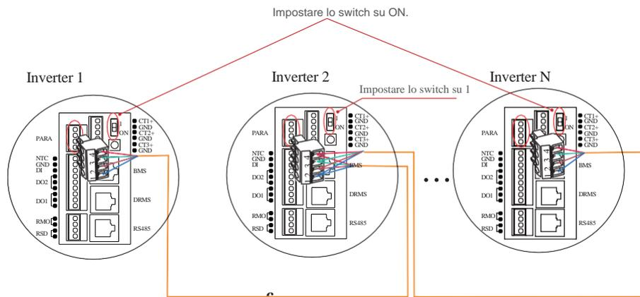
È necessario impostare lo switch della resistenza dell'inverter 1 e dell'inverter N (ultimo) su "ON" e impostare le resistenze di tutti gli altri inverter connessi in parallelo su "1"
