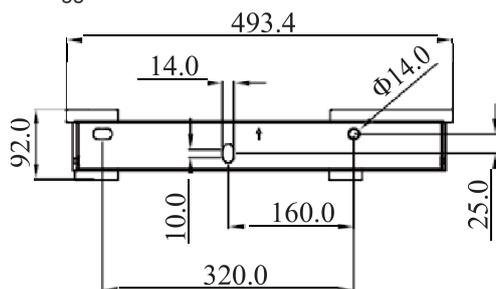
1. Usare una livella a bolla per tracciare i 3 fori necessari al fissaggio della staffa. Fare riferimento alla figura a. Effettuare i 3 fori di 16mm di diametro e 55mm di profondità. Fare riferimento alla figura b.
