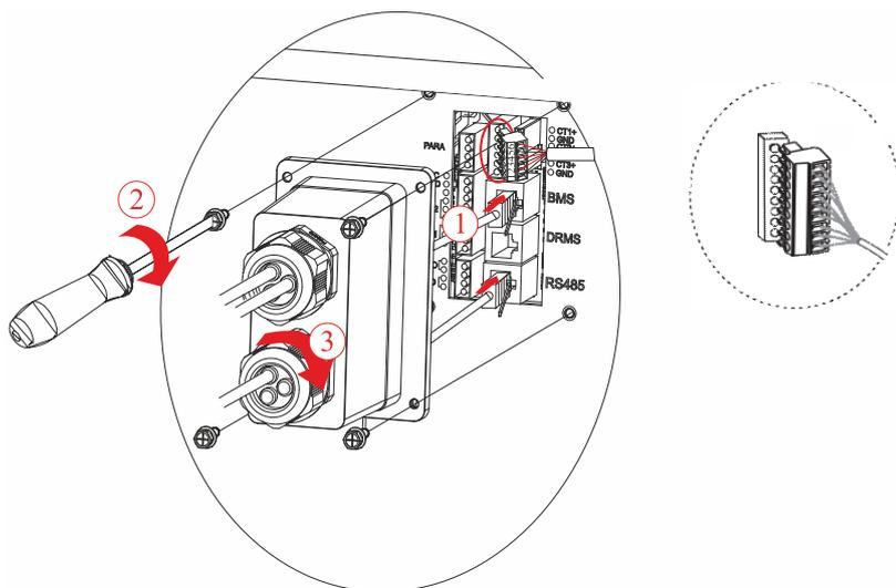
Inserire il terminale a 9 pin nella porta corrispondente di NTC/DI/DO nell'inverter ESS trifase. Ricordarsi di chiudere correttamente la copertura impermeabile con 4 viti M4; 1.2Nm
