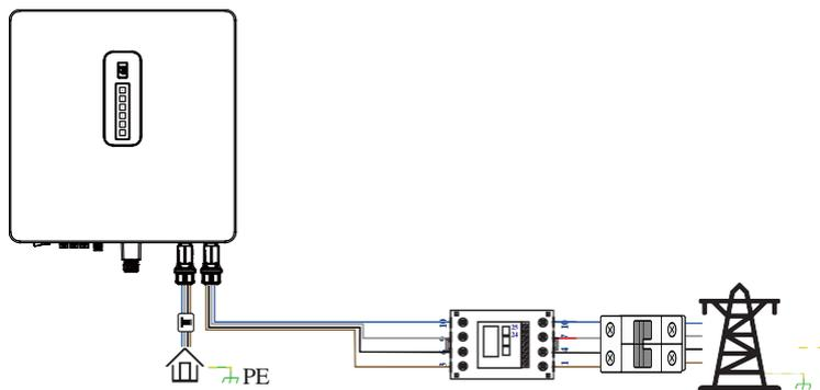
In caso di 3 o più inverter in parallelo l'energy meter deve essere connesso come di seguito:
